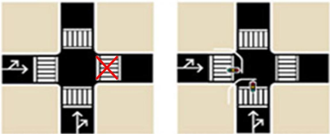
QUANDO A FAIXA DE TRAVESSIA DE PEDESTRES FOR IMPLANTADA EM CRUZAMENTOS COM CONVERSÕES SEM SEMAFOROS ELA DEVE SER IMPLANTADA NA VIA PREFERENCIAL ANTES DO ALINHAMENTO DA VIA SECUNDÁRIA TRANSVERSAL, PARA QUE OS VEÍCULOS DESSA VIA POSSAM APROVEITAR O MOMENTO DA PARADA DO FLUXO DE VEÍCULOS DA PREFERENCIAL PARA TRAVESSIA DE PEDESTRES PARA EFETUAREM O CRUZAMENTO A VIA PREFERENCIAL OU EFETUAREM A CONVERSÃO.
